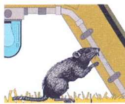
Protection du câblage au travers des balles de foin
